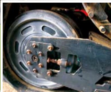
ne pose aucun problème pour atteler un outil. Les chandelles ont simplement été allongées à l'aide du filetage. Une interface est attelée entre le tracteur et l'outil afin que ce dernier ne touche pas le train arrière avec le combiné de semis ou le déchaumeur.
